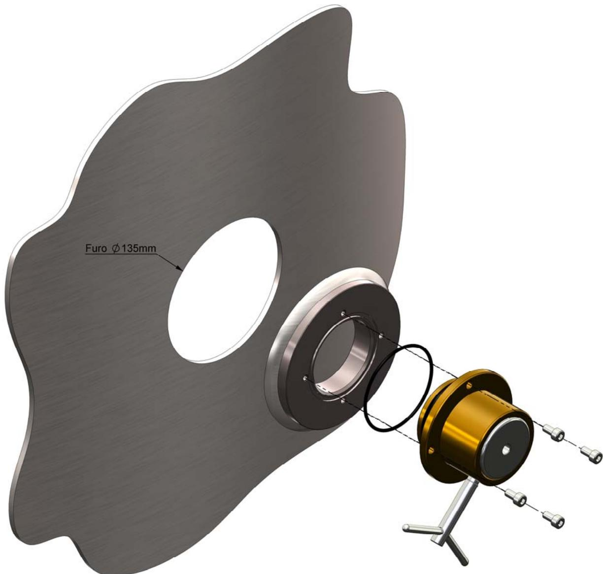
Após a soldagem da Flange deve-se aguardar o resfriamento das peças e somente após esta constatação realizar a montagem dos demais componentes da mesma.
